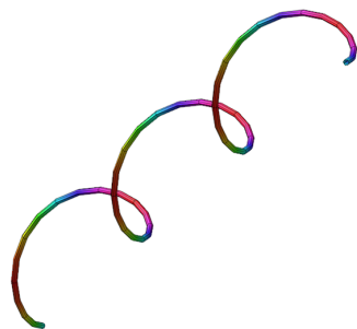
شکل ۶. حرکت ذره‌ی بارداری با بار مثبت در میدان‌های متعامد الکتریکی و مغناطیسی
